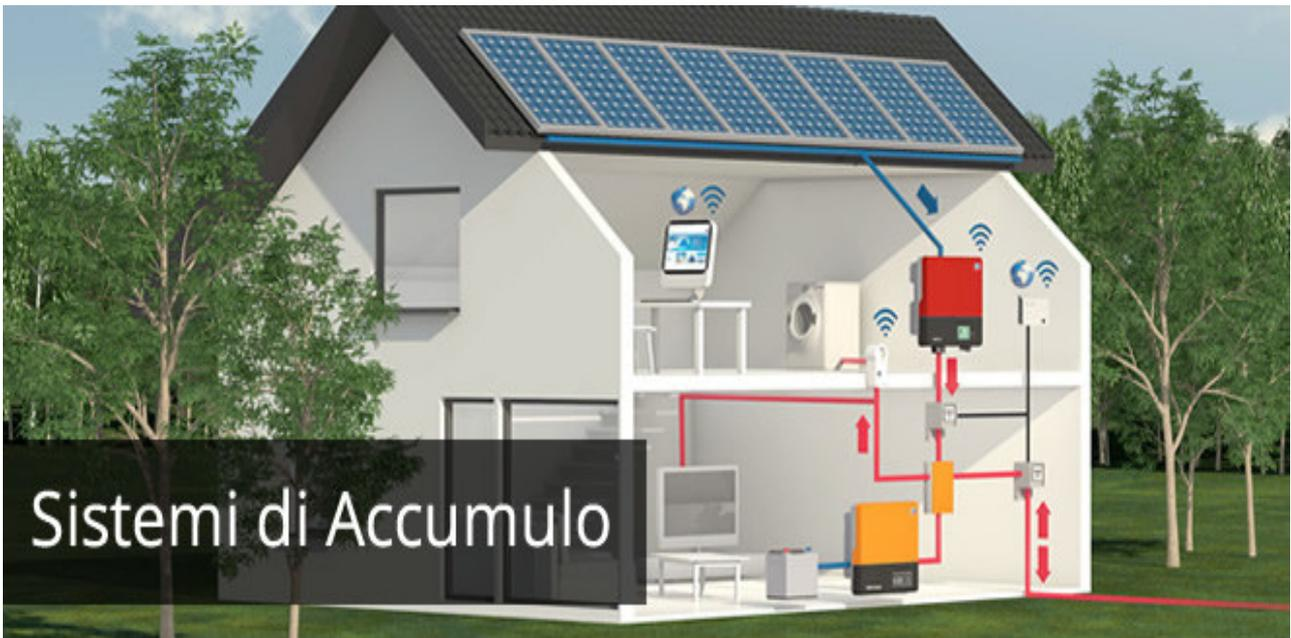
Il sistema di accumulo dell'impianto fotovoltaico permette di immagazzinare l'energia prodotta dall'impianto che non viene istantaneamente consumata dalle utenze domestiche, per poter essere riutilizzata poi nelle ore serali, quando la produzione dell'impianto è nulla.
